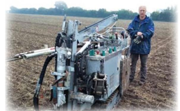
Probenentnahmen für die Bodenuntersuchungen
